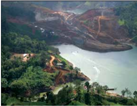
Figura 17. Deslizamiento, derrumbe de suelos Acrisol, rocas sedimentarias y "tapón" sobre el río Grijalva en la zona norte de Chiapas. noviembre de 2007. Foto: Silvia Ramos H.
